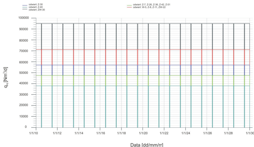
Rys. 17. Tworzenie buforu magazynu. Wariant I – wydajności zatłaczania CO 2 przez poszczególne odwierty zatłaczające
