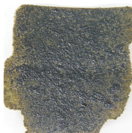
Rys. 7. Osad wytrącony w wyniku kontaktu ropy z odwiertu M-7 z cieczą o składzie: 15% HCl + 0,2% inhibitora korozji + 20 000 ppm Fe
