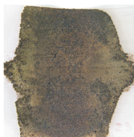
Rys. 5. Osad wytrącony w wyniku kontaktu ropy z odwiertu M-7 z cieczą o składzie: 15% HCl + 0,2% inhibitora korozji
