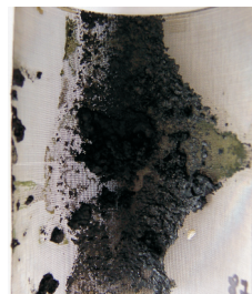
Rys. 2. Osad wytrącony w wyniku kontaktu ropy z odwiertu B-9 z cieczą o składzie: 15% HCl + 0,2% inhibitora korozji + 10 000 ppm Fe
