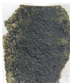
Rys. 8. Osad wytrącony w wyniku kontaktu ropy z odwiertu M-7 z cieczą o składzie: 15% HCl + 0,2% inhibitora korozji + 40 000 ppm Fe
