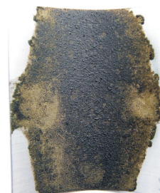
Rys. 6. Osad wytrącony w wyniku kontaktu ropy z odwiertu M-7 z cieczą o składzie: 15% HCl + 0,2% inhibitora korozji + 10 000 ppm Fe
