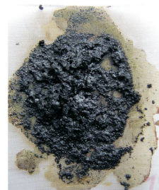
Rys. 4. Osad wytrącony w wyniku kontaktu ropy z odwiertu B-9 z cieczą o składzie: 15% HCl + 0,2% inhibitora korozji + 40 000 ppm Fe
