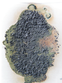
Rys. 1. Osad wytrącony w wyniku kontaktu ropy z odwiertu B-9 z cieczą o składzie: 15% HCl + 0,2% inhibitora korozji
