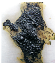
Rys. 3. Osad wytrącony w wyniku kontaktu ropy z odwiertu B-9 z cieczą o składzie: 15% HCl + 0,2% inhibitora korozji + 20 000 ppm Fe
