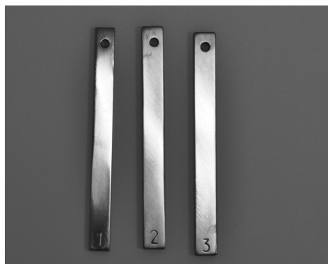
Fot. 2 Próbki wykonane ze stali L80 13Cr, po teście korozyjnym pod ciśnieniem 9 MPa w temperaturze 80°C, w środowisku gazu pobranego z głowicy odwiertu R-44, z dodatkiem inhibitora korozji C-8
