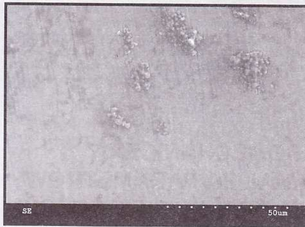
RYS. 6. Morfologia powierzchni powłoki Al_2O_3-TiO_2 po inkubacji w SBF i myciu w myjce ultradźwiękowej w wodzie destylowanej. FIG. 6. SEM image of dual Al_2O_3-TiO_2 coating surface after incubation in SBF and ultrasonic washing in distilled water.
