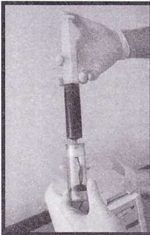
RYS. 2. Wkładanie zbiornika do wirówki. FIG. 2. Insertion of container into centrifuge.
