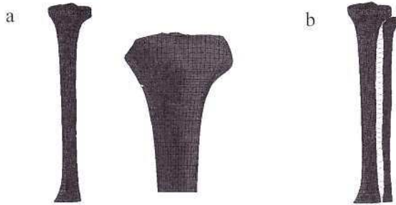
RYS. 1. Model MES kości piszczelowej (a), kompleksu kości podudzia (b). FIG. 1. FE models of tibia bone (a) and lower limb bones complex (b).
