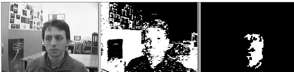
Rys. 10. Etapy kalibracji. Po lewej obraz źródłowy z kamery, pośrodku maska wyznaczona na podstawie progów HSV, po prawej maska obiektu na pierwszym planie
