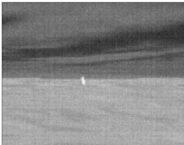
Rys. 6. Obraz pojedynczego żołnierza uzyskany z wykorzystaniem niechłodzonej kamery termowizyjnej o średnim polu widzenia w warunkach lekkiej mgły z odległości 500 m
