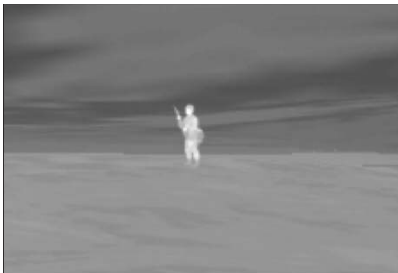
Rys. 5. Obraz pojedynczego żołnierza uzyskany z wykorzystaniem chłodzonej kamery termowizyjnej o wąskim polu widzenia w warunkach lekkiej mgły z odległości 1000 m
