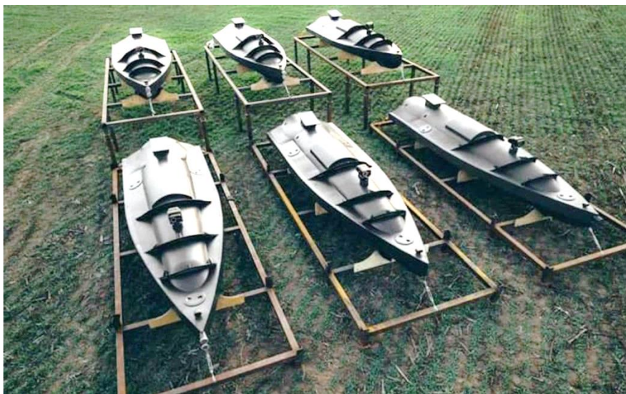
Fot. 1. Kilka gotowych USV Mykola-3. Ich wyposażenie jest nieco inne od tego, które było zamontowane na dronie porzuconym 21 września 2022 r. na brzegu w pobliżu Sewastopola (Źródło: Ministerstwo Obrony Ukrainy)
