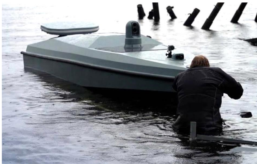
Fot. 2. USV MAGURA V5. Dobrze widoczne najważniejsze elementy wyposażenia, czyli kamera oraz anteny środków łączności (Źródło: Ministerstwo Obrony Ukrainy)
