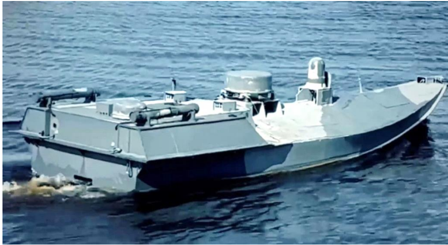
Fot. 3. Dron Sea Baby, którego przenoszony ładunek wybuchowy jest szacowany nawet na 850 kg (Źródło: Służba Bezpieczeństwa Ukrainy)
