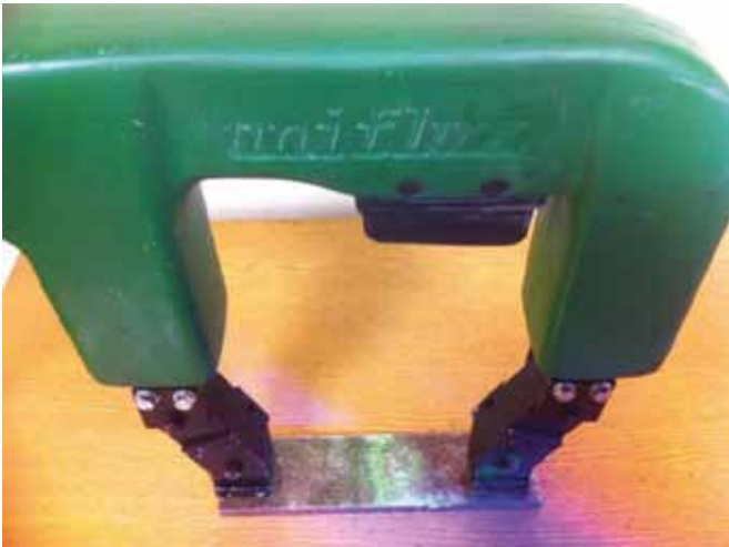
Rys. 2.13. Przykład wykrywania defektu podpowierzchniowego proszkiem magnetycznym fluorescencyjnym (materiał ferromagnetyczny, częstotliwość magnesowania 50 Hz)
