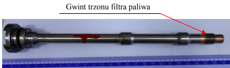
Rys. 1. Wycofany z eksploatacji trzon z filtra paliwa. Na gwincie widoczna powłoka galwaniczna, mająca poprawić własności trybologiczne
