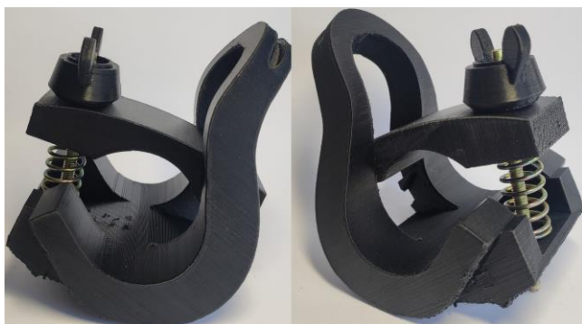
Rys.9. Uchwyt przelotowy linii napowietrznej izolowanej wykonany w technologii druku 3D (Źródło: opracowanie własne)
