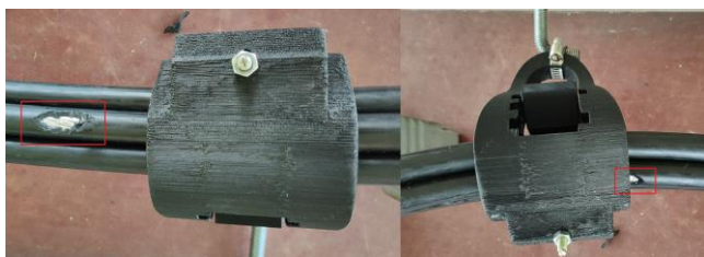
Rys.10. Uchwyt przelotowy z zamontowanym odcinkiem przewodu uszkodzoną izolacją (Źródło: opracowanie własne)
