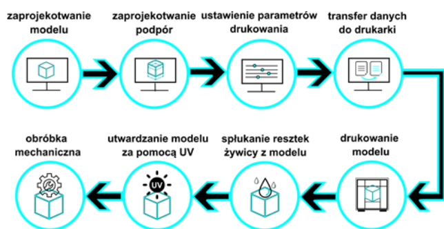
Rys.4. Proces wytwarzania modelu – druk 3D w technologii SLA (Źródło: opracowanie własne)
