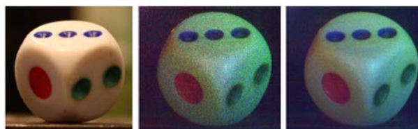
Ryc. 6. Barwne obrazowanie bezsoczewkowe w trybie holografii cyfrowej. Od lewej do prawej: przedmiot, odtworzenie hologramu cyfrowego z jednej ekspozycji, uśrednione odtworzenia z czterech kolejnych ekspozycji pozwalają na zmniejszenie widoczności szumu koherentnego [13]
