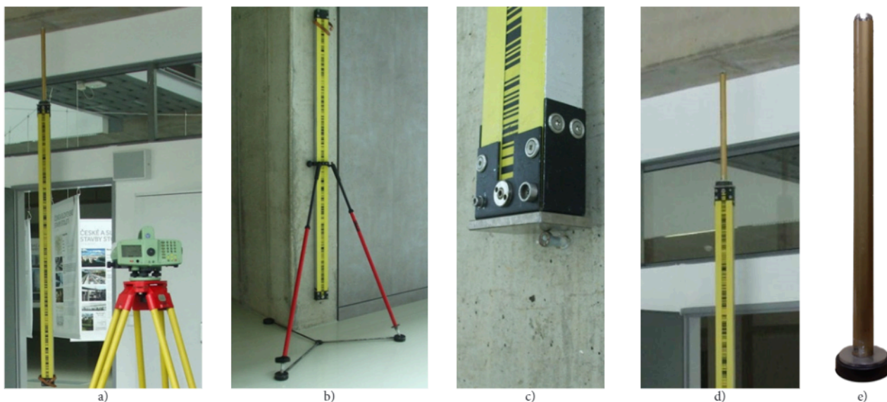
Fig. 5. Position of the invar bar code rod from the ceiling and on the point Rys. 5. Położenie inwarowego pręta kodu kreskowego od sufitu i na punkcie
