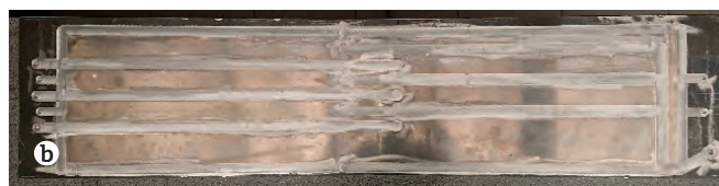
Rys. 7. Schemat budowy korpusu z kanałem chłodzącym (a) oraz widok kadłuba po procesie zgrzewania FSW (b)
