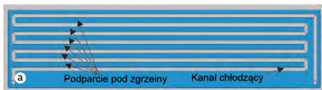
Rys. 7. Schemat budowy korpusu z kanałem chłodzącym (a) oraz widok kadłuba po procesie zgrzewania FSW (b)
