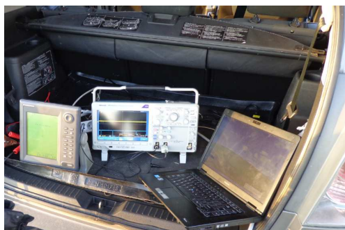
Rys. 2. Zestaw pomiarowy do rejestracji sygnału wizji z radaru
