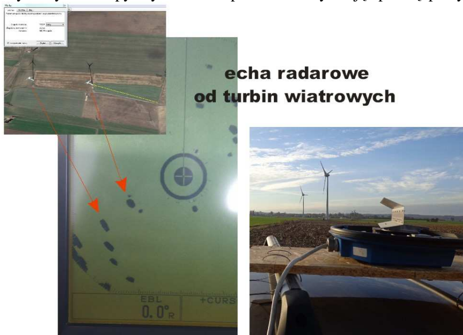
Rys. 4. Echa od turbin wiatrowych na wskaźniku Furuno 821 Źródło: [Opracowanie własne]
