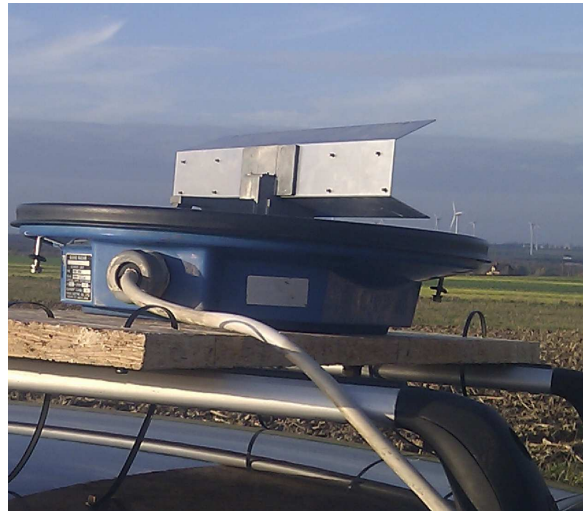
Rys. 6. Ustawienie anteny radarowej na azymut stojących wiatraków Źródło: [Opracowanie własne]
