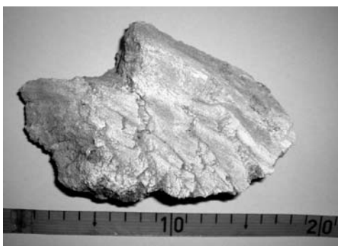
RYSUNEK 4. Widok z góry na struwit wykrystalizowany w GOS w Łodzi FIGURE 4. Top view of the crystallized struvite in sewage treatment plant in Łódź
