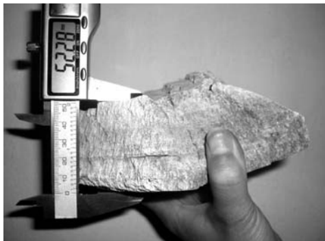
RYSUNEK 3. Widok z boku na struwit wykrystalizowany w rurociągach GOS w Łodzi FIGURE 3. Side view of the crystallized struvite in pipes of sewage treatment plant in Łódź
