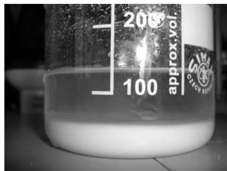
RYSUNEK 1. Struwit wytworzony w warunkach laboratoryjnych
