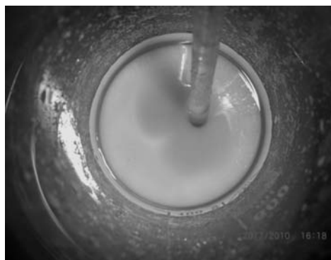
RYSUNEK 2. Widok na zlewkę z wytworzonym struwitem
