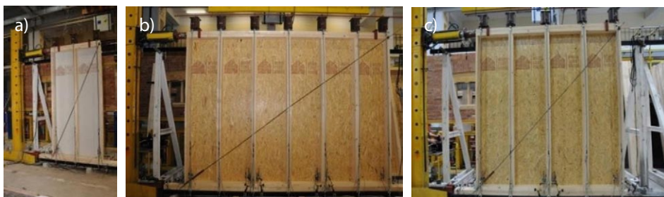
Rys. 6. Widoki wybranych modeli na stanowisku badawczym: a) pojedynczego modułu pełnego z poszyciem z płyty gipsowo-włóknowej, b) układu liniowego dwóch modułów z poszyciem z płyty OSB, c) układu liniowego trzech modułów z poszyciem z płyty OSB
