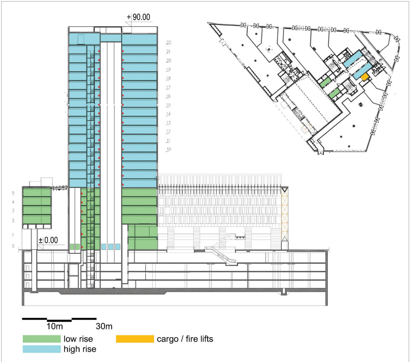
Rys. 1. Przekrój oraz rzut parteru budynku ze wskazaniem grup wind oraz ich zakresu działania; źródło: opracowanie autora
