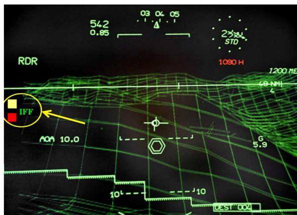
Fot. 4. Widok obrazu z systemu nahałmowego sterowania uzbrojeniem z uwzględnieniem systemu IFF [2]
