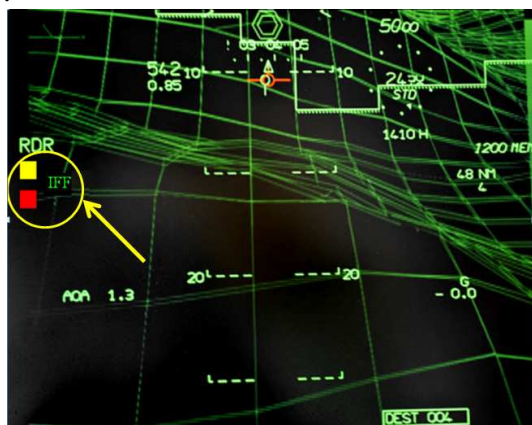
Fot. 3. Przykładowe zobrazowanie znacznika systemu IFF oraz parametrów pilotażowo-nawigacyjnych [2]
