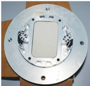
Rys. 11. Widok tylnej płaszczyzny integratora przygotowanej do montażu pojemnika z pakietem elektroniki
