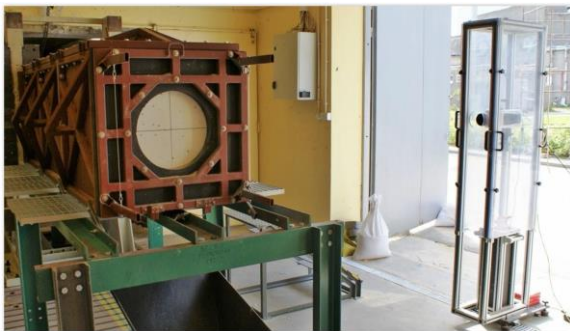
Rys. 20. Widok stanowiska hamującego i przygotowanej do testu kamery zamontowanej w obudowie ochronnej
