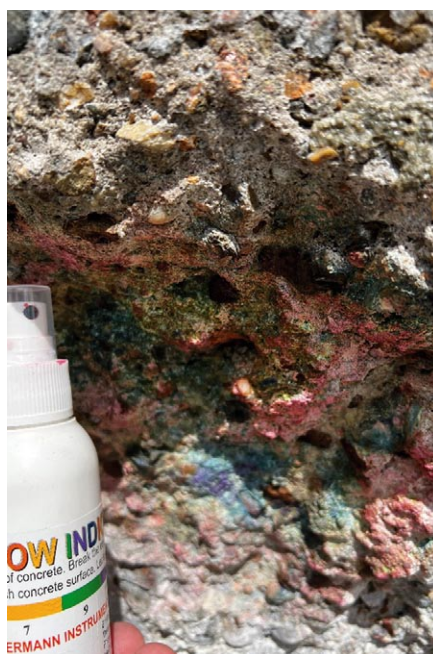
Rys. 7. Test tęczowy (Rainbow Indicator) na powierzchni betonu podczas skuwania zdegradowanej warstwy (archiwum autora)
