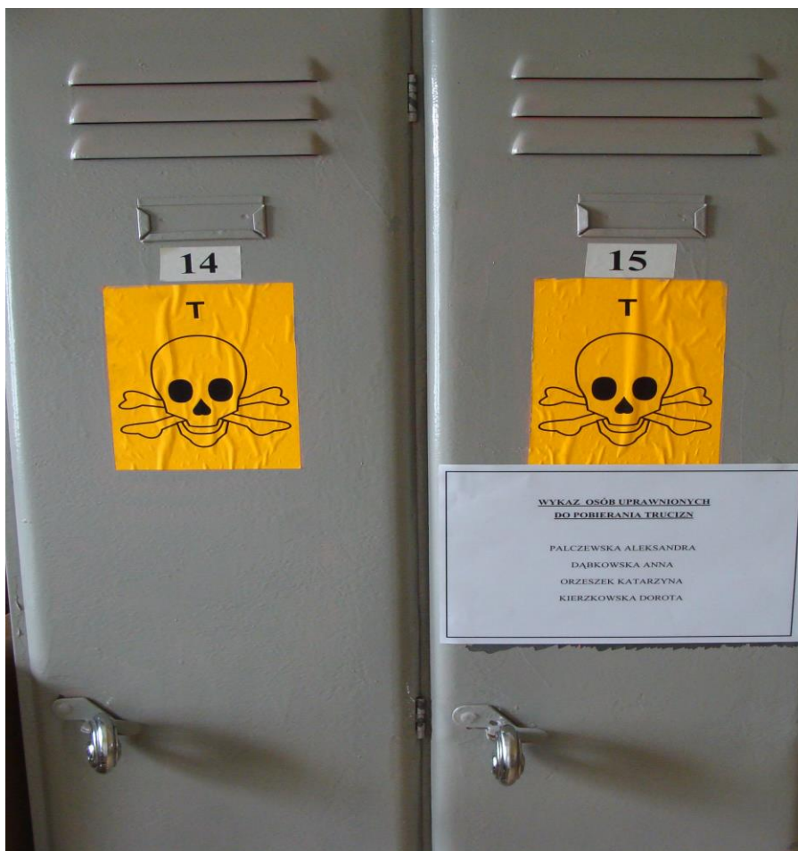
Fot. 1 Przykład oznakowania i zabezpieczenia szafy do przechowania cyjanków (fot. A. Palczewska, WZU S.A., 04.2017 r.)
