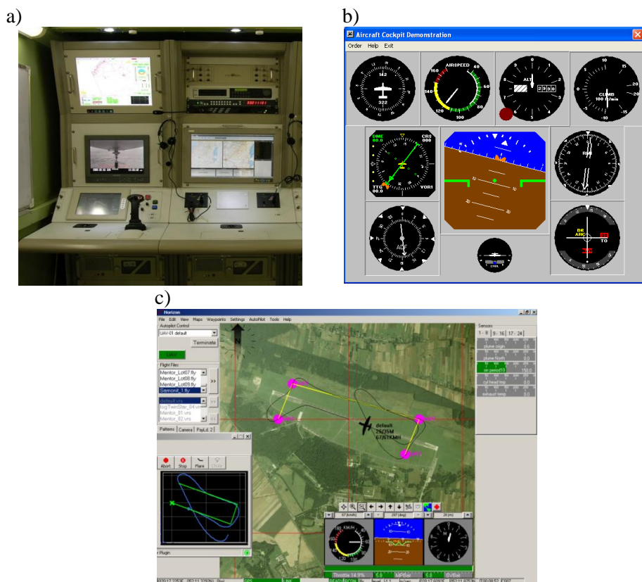
Rys. 4 Stanowisko kierowania i kontroli lotu BSYP: a) widok ogólny, b) prezentacja graficzna parametrów pilotażowo-nawigacyjnych, c) mapa zobrazowania planowanej i realizowanej trasy lotu
