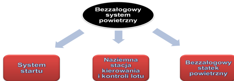
Rys. 1 Schemat bezzałogowego systemu powietrznego
