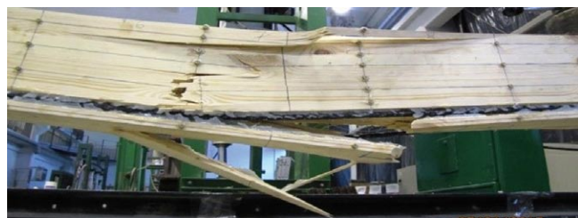
Rys. 4. Postać zniszczenia belki wzmocnionej prętami BFRP (B)
