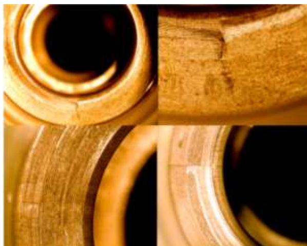
Rys. 19. Pęknięcia korpusów wtryskiwacza Common Rail
