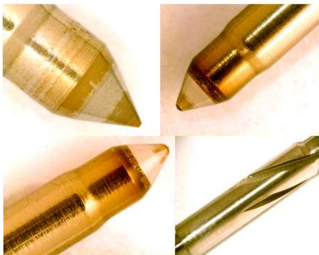
Rys. 5. Przykłady zużycia ściernego iglic rozpylaczy wtryskiwaczy Common Rail
