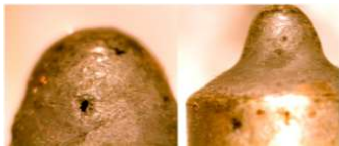
Rys. 3. Zakokosowanie otworków rozpylaczy
