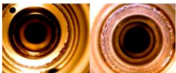
Rys. 18. Korozja na powierzchniach korpusów wtryskiwacza Common Rail
