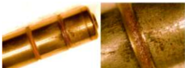
Rys. 16. Korozja na trzpieniu zaworu sterującego wtryskiwacza Common Rail
