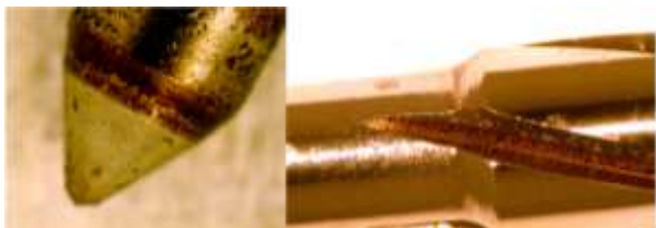
Rys. 17. Korozja na iglicach rozpylaczy wtryskiwacza Common Rail
