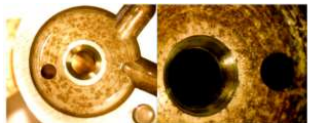
Rys. 14. Korozja na powierzchni gniazd zaworów sterujących wtryskiwaczy Common Rail
