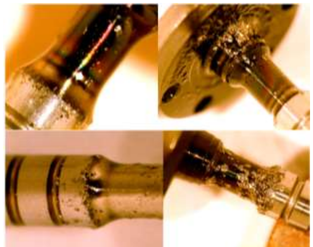
Rys. 7. Obecność opiłków na trzpieniach zaworów sterujących wtryskiwaczy elektromagnetycznych powodujących zużycie ściernie
