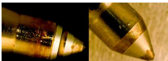
Rys. 4. Uszkodzenia iglic rozpylaczy w wyniku wyraźnego miejscowego przegrzania
