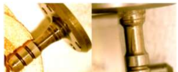
Rys. 15. Korozja pod talerzykiem trzpieni zaworów sterujących wtryskiwaczy elektromagnetycznych Common Rail
