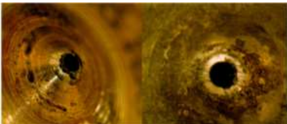
Rys. 11. Przykłady uszkodzeń otworu i powierzchni gniazda zaworu sterującego wtryskiwaczy elektromagnetycznych wraz z wyraźnie widocznymi śladami korozji
