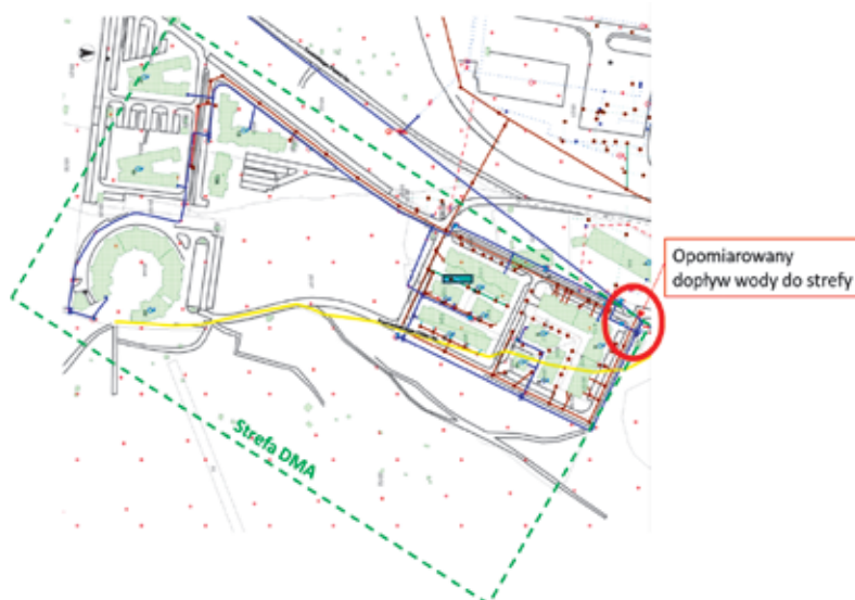
Ryc. 2. Widok mapy GIS badanego osiedla z zaznaczonym przebiegiem sieci wodociągowej i miejscem odgażnienia z rurociągu magistralnego, kolorem czerwonym wyróżniono odgażnienie z magistrali wodociągowej wraz z komorą redukcyjno-pomiarową
