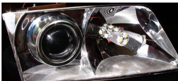
Rys. 6. Lampa z zamontowaną „żarówką”
