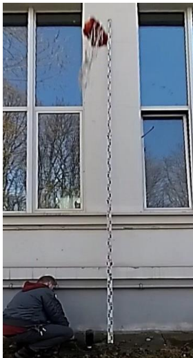
Rys. 9. Stanowisko badawcze do wyznaczenia prędkości wystrzeliwania spadochronu
