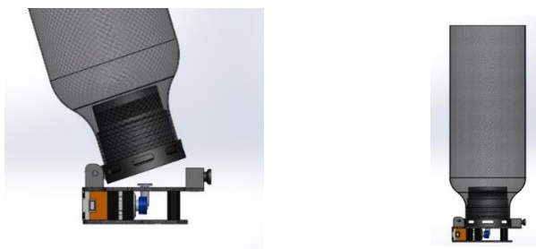
Rys. 2. Widok pneumatycznego spadochronowego systemu ratunkowego
