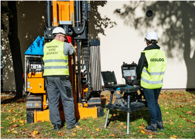
Ryc. 4. Sondowanie dylatometryczne, fot. M. Szlasa
