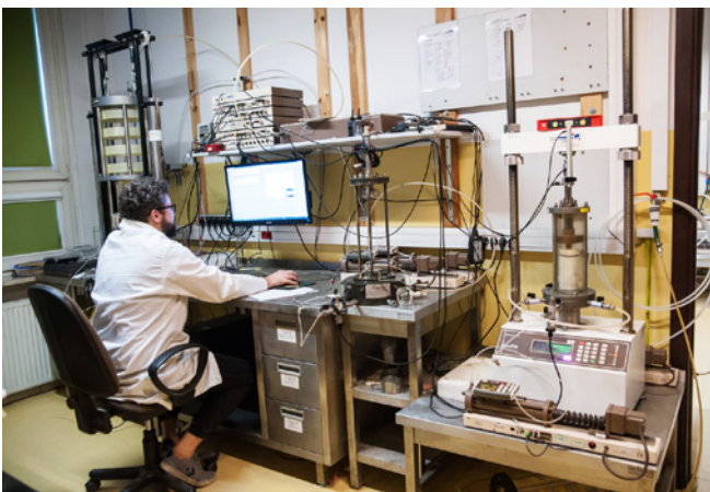
Ryc. 5. Badania w aparacie trójosiowym, fot. M. Szlasa
