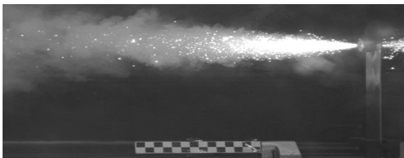
Rys. 15. Efekt wizualny uzyskany po zapaleniu ładunku wzmacniającego w postaci zaprasowanego prochu czarnego po czasie 70 000 [μs]
