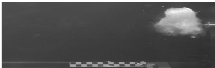
Rys. 12. Efekt wizualny uzyskany po zapaleniu ładunku wzmacniającego z prochu czarnego w postaci sypkiej po czasie 700 [μs]
