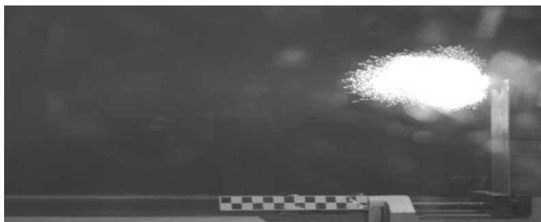
Rys. 13. Efekt wizualny uzyskany po zapaleniu ładunku wzmacniającego w postaci zaprasowanego prochu czarnego po czasie 500 [μs]
