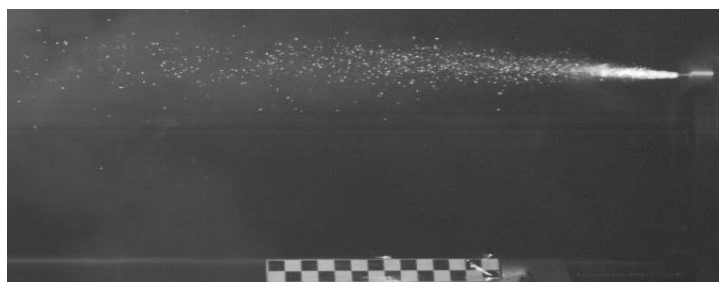
Rys. 19. Efekt wizualny uzyskany po zapaleniu ładunku wzmacniającego w postaci zaprasowanej mieszaniny pirotechnicznej po czasie 70 000 [μs]
