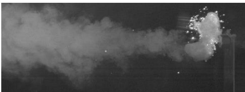
Rys. 16. Efekt wizualny uzyskany po zapaleniu ładunku wzmacniającego w postaci zaprasowanego prochu czarnego po czasie 100 000 [μs]
