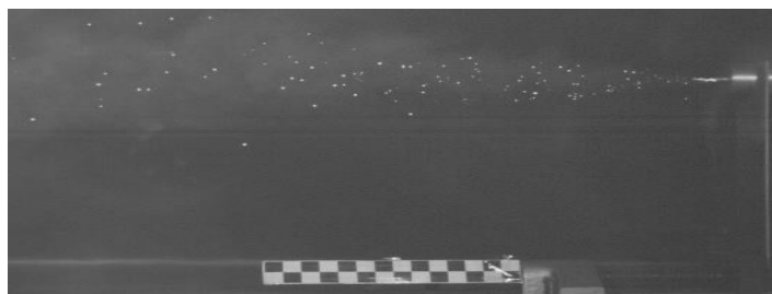
Rys. 20. Efekt wizualny uzyskany po zapaleniu ładunku wzmacniającego w postaci zaprasowanej mieszanki pirotechnicznej po czasie 100 000 [μs]
