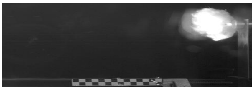
Rys. 11. Efekt wizualny uzyskany po zapaleniu ładunku wzmacniającego z prochu czarnego w postaci sypkiej po czasie 300 [ \mu s] Fig. 11. Visual effect produced after ignition of the booster charge made of the loose black powder after 300 [ \mu s]
