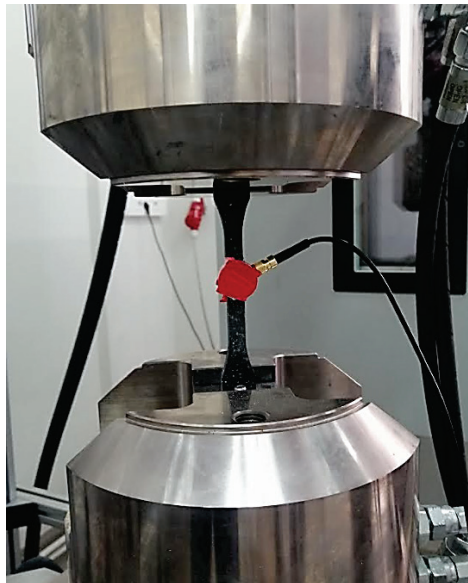
Rys. 3. Przykładowa próbka w trakcie statycznej próby rozciągania
