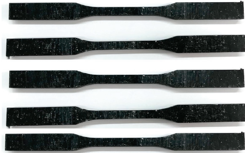
Rys. 2. Przykładowe próbki przygotowane do statycznej próby rozciągania
