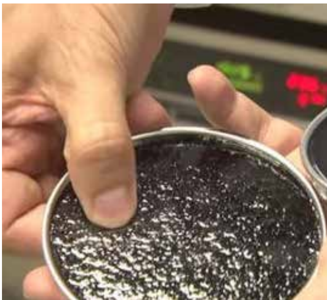
Fot. 1. Próbkę asfaltu modyfikowanego gumą [13]
