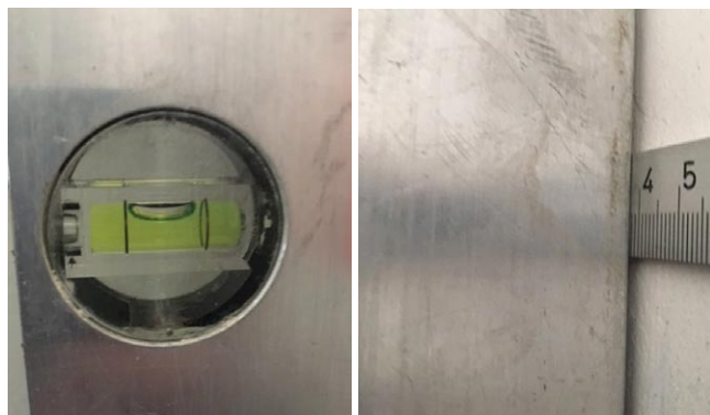
Rys. 2. Widok łąty i libelli w trakcie pomiaru odchylenia od pionu (źródło własne)
