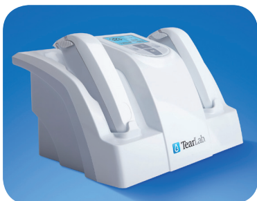
Ryc. 8. Urządzenie do pomiaru osmolarności filmu łzowego [https://www.labtician.com/therapeutics/product/tearlab/]
