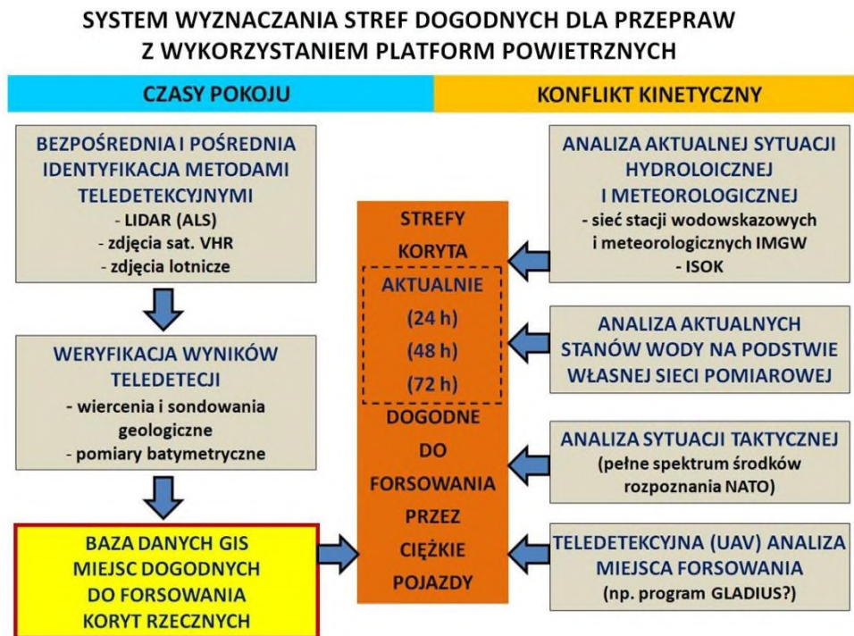
Rys. 6. Uproszczony schemat SYSTEMU WYZNACZANIA STREF DOGODNYCH DLA PRZEPRAW Z WYKORZYSTANIEM PLATFORM POWIETRZNYCH
