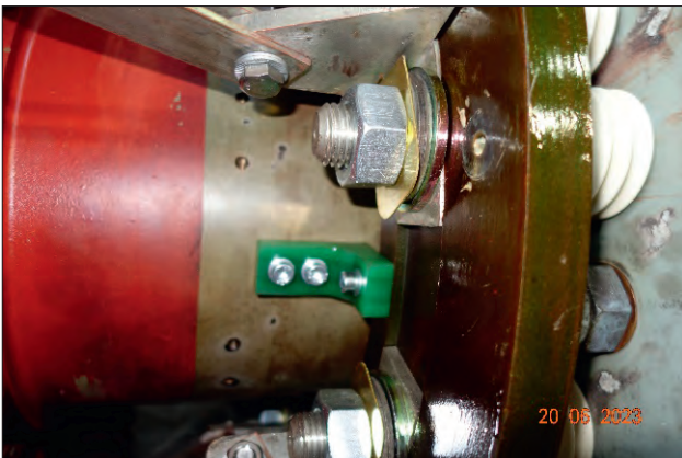
Rys. 8. Widok połączenia tarczy tekstolitowej z wałem silnika w celu odprowadzenia ładunków elektrostatycznych [opr. wł.]
