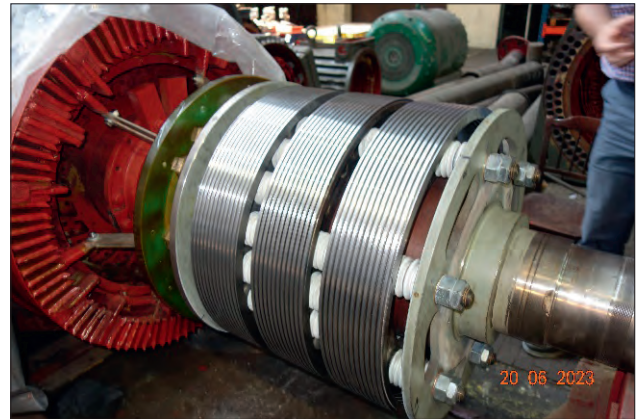
Rys. 9. Widok na wyremontowaną głowicę silnika pierścieniowego z widocznymi nowymi elementami łączeniowymi i uzwojeniem wirnika [opr. wł.]
