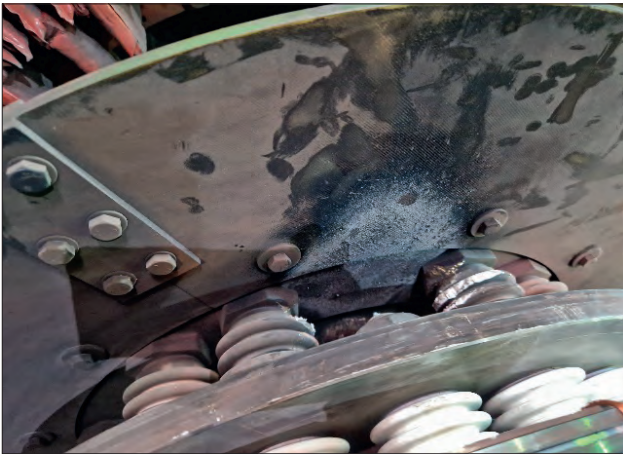
Rys. 7. Widok części głowicy silnika pierścieniowego objętej działaniem łuku elektrycznego w wyniku czego uszkodzeniu uległy izolatory porcelanowe oraz tarcza złożona z dwóch półpierścieni [opr. wł.]
