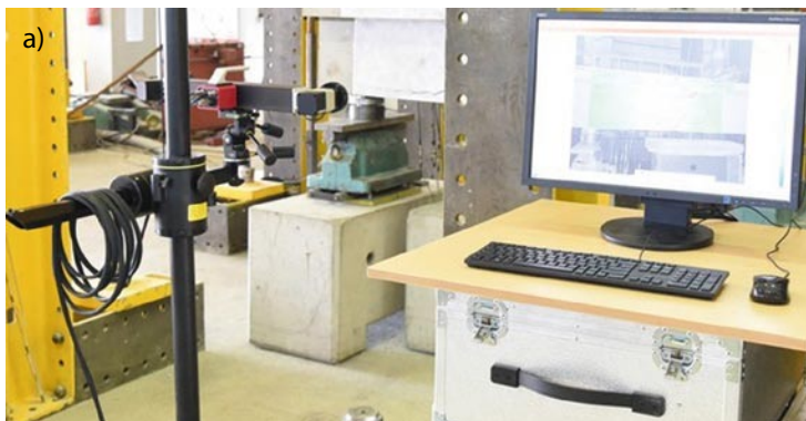
Rys. 2. Stanowisko do pomiaru metodą cyfrowej korelacji obrazu i mapa odkształceń głównych na powierzchni jednego z badanych elementów (kolor czerwony oznacza rysy)
