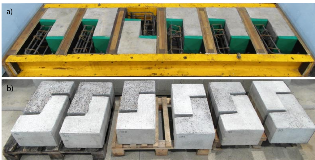
Rys. 3. Przygotowywanie elementów: a) bloki podłoża i zbrojenie umieszczone w formach, b) widok elementów po wyjęciu z formy
