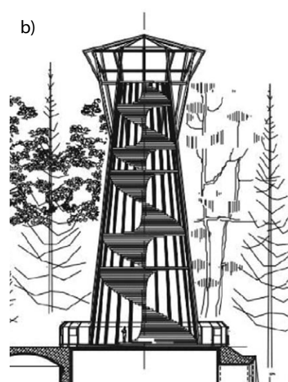
Rys. 2. Drewniana wieża widokowa w Lozannie w parku Sauvabelin, a) widok [zdjęcie autorki], b) przekrój [3]
