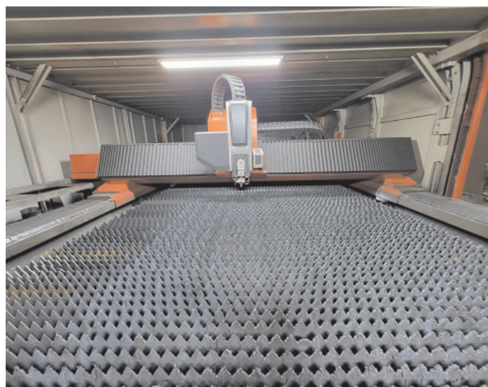
Rys. 6. Most tnący i wóz z zamontowaną głowicą oraz krata do mocowania blach na stole roboczym. Wycinarka laserowa ByStar Fibre 6255 firmy Bystronic
