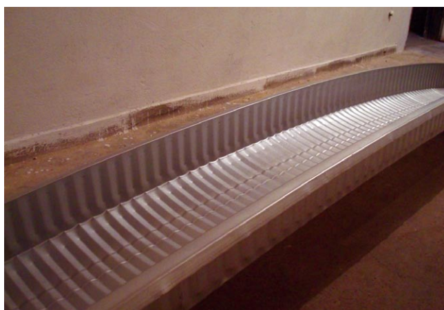
Rys. 10. Pojedynczy panel wygięty w łuk
