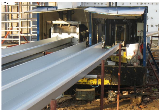
Rys. 9. Powstawanie panelu prostego
