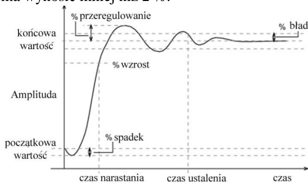
Rys. 3. Ograniczenia przy dobieraniu nastaw regulatora w celu określenia odpowiedzi układu na skokowe wymuszenie
