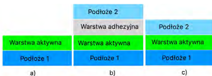
Ryc. 1 Budowa filmów radiochromowych: a) typ I, b) typ II, c) typ III Źródło: Opracowanie własne na podstawie [3, 26].
