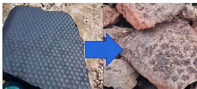
Ryc. 3. Wygląd toksycznych osadów przed i po termicznej desorpcji
