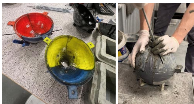
Rys. 2. Formy szalunkowe oraz układanie mieszanki betonowej w formach
