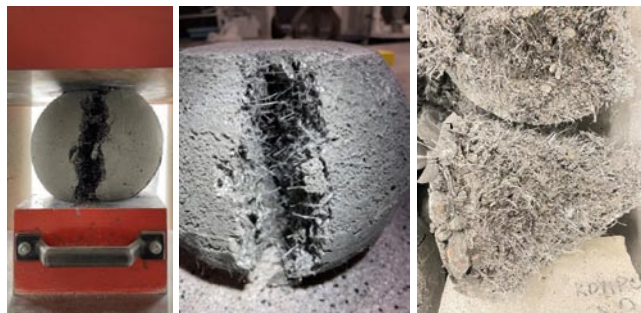
Rys. 5. Kule w trakcie badań i po badaniu
