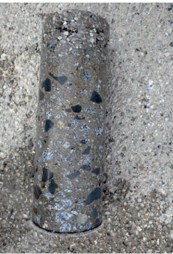
Przykład rysy w przekroju odwiertu wg tabeli 1/4 (średnia)
