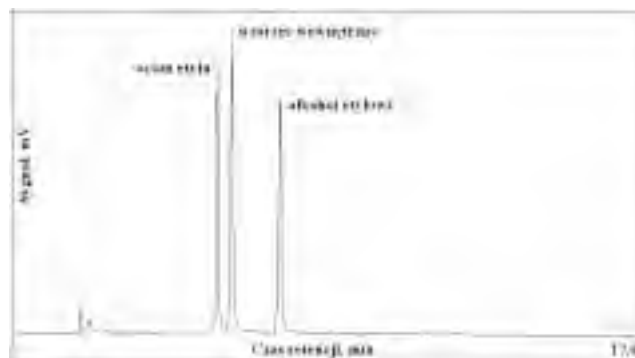
Rys. 7. Chromatogram z analizy mieszaniny alkoholu etylowego i octanu etylu w benzynie bazowej, wykonany na analizatorze O-FID według metody PN-EN 1601
