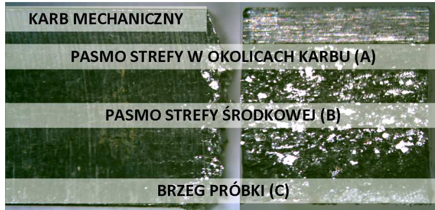
Rys. 3. Strefy obserwacji przełomu próbki udarnościowej
