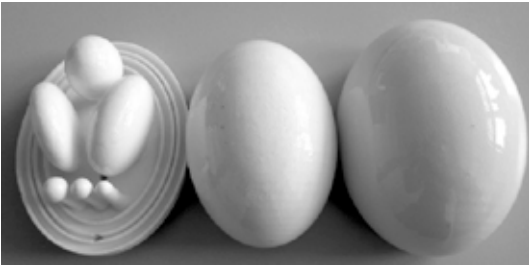
Ryc. 4 Wydrukowany fantom Shepp-Logana za pomocą drukarki 3D Źródło: Publikacja NOTE 3 D-Printed Shepp-Logan Phantom as a Real-World Benchmark for MRI autorstwa J. Kasten, T. Vetterli, F. Lazeyras, D. Ville.
