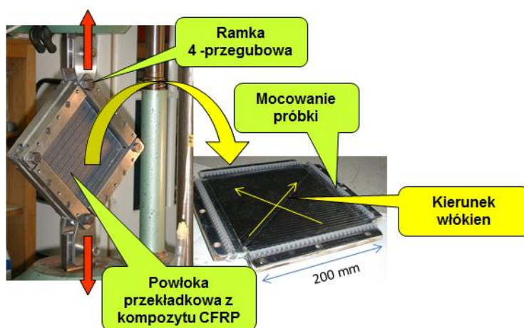
Rys. 4 Widok próbki do badań zdolności przenoszenia obciążeń tnących
