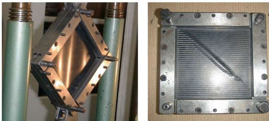
Rys. 9 Utrata stateczności powłok poddanych obciążeniom tnącym (z lewej laminarna w trakcie obciążenia – z prawej przekładkowa po zniszczeniu)
